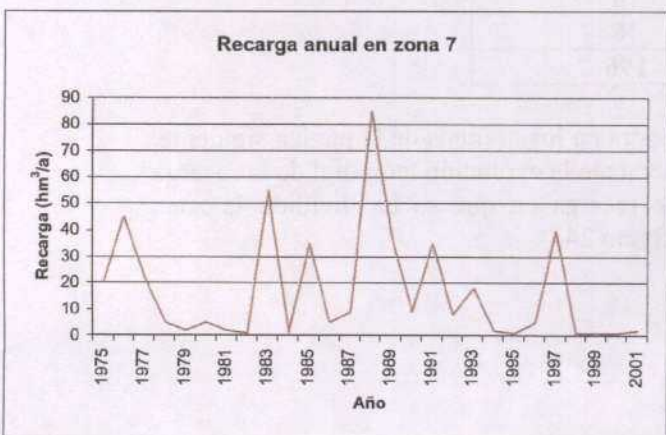
Figura 31. Distribución anual de la recarga natural en las diferentes zonas en que se ha dividido el área modelada.
