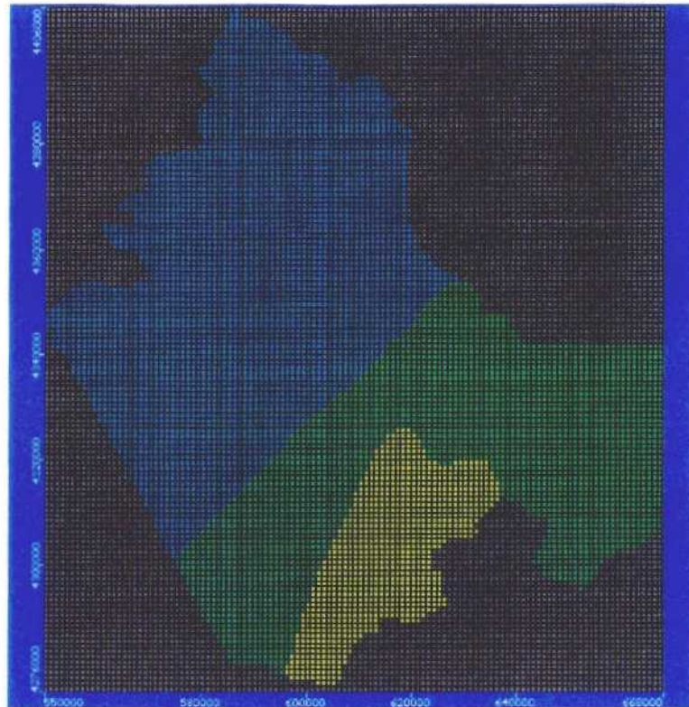
Figura 20. Distribución espacial de la conductividad hidráulica en la capa 4.
