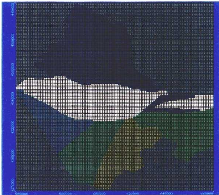
Figura 18. Distribución espacial de la conductividad hidráulica en la capa 2.
