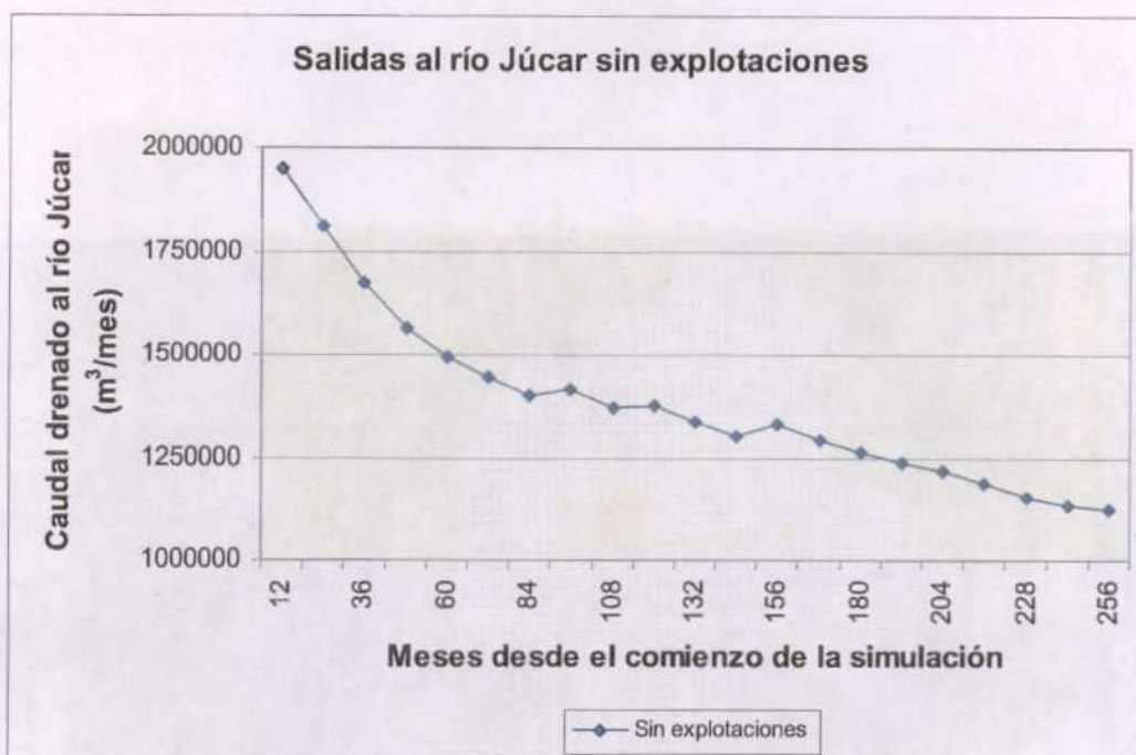
Figura 44. Evolución temporal de las descargas subterráneas al río Júcar en el caso de explotación cero en la unidad hidrogeológica.
